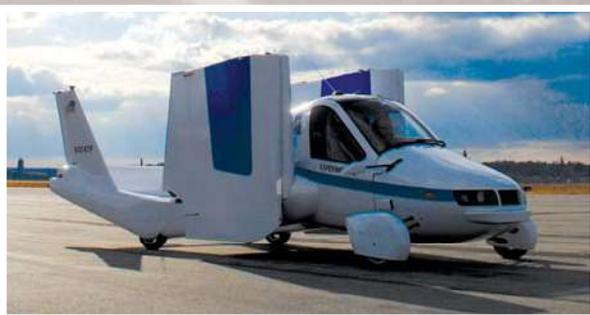
La Terrafugia Transition est la première voiture volante au monde. Elle fait 8 m de largeur lorsque ses ailes sont déployées. Ce véhicule peut voler jusqu'à 3 000 m d'altitude à une vitesse de pointe de 185 km/h. Munie de pneus, elle peut atterrir presque partout, mais requiert une piste d'au moins 762 m pour décoller. Si une telle voiture t'intéresse, commence à amasser tes sous, car elle coûte 280 000 \$.
